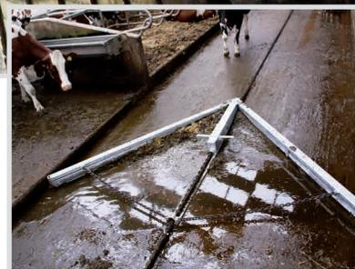
Schieberanlagen für Spaltböden und planbefestigte Böden
