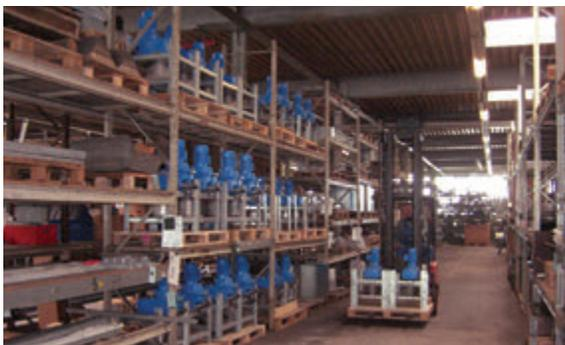
**DURÄUMAT-Güllepumpen** werden am Standort Reinfeld nach dem bewährten System ORIGINAL-BEHAM gefertigt. Alle Pumpentypen sind mit einem gusseisernen Pumpengehäuse ausgestattet. Laufrad und Einzugsring verfügen über aufgeschweißte Hartmetall-Reißkanten und garantieren eine hohe Leistung auch bei dickster Gülle.
